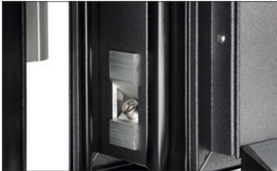
Stabile Eckverbindungen Profile auf Gehrung verschraubt, verklebt und verbolt
