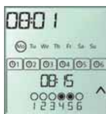
Montags, 8:15 Uhr: AUF-Befehl an Kanäle 4+5
